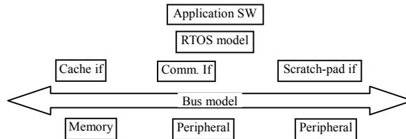
**Fig. 8.** Platform model built using SCoPE tool
